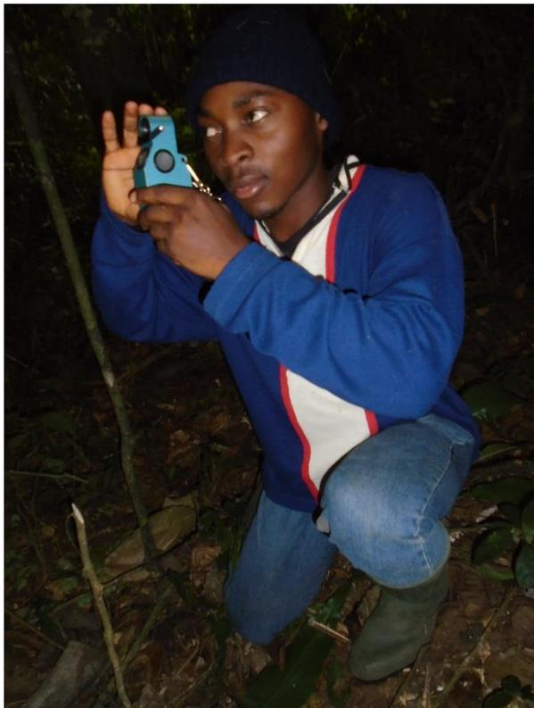
Fig.7. Mesure des hauteurs et des diamètres de l'arbre par la méthode indirecte à l'aide du relaskope
